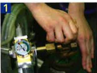
炭酸ガスシリンダーの元栓バルブを閉じます。
