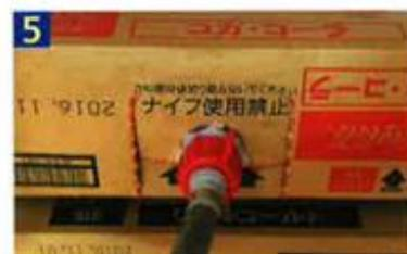
接続されたバルブ・コネクタ部分が、カートンから飛び出してしまう位置にあることを確認します。
