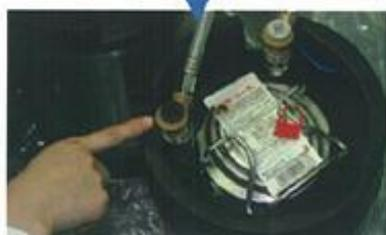
シロップタンクの2ピンコネクタ(炭酸ガスのIN側)を反対方向に回し外す。次に3ピンコネクタ(シロップOUT側)を外す。
