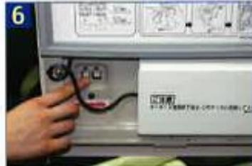
PXTの売り切れランプ(赤)が点灯しているため、該当のPXTリセットスイッチを押し、売り切れランプが消えるのを確認する。
