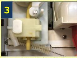
左右のチューブポンプ本体底面や希釈水ノズルを水とI型ブラシ、ノズルブラシで洗浄する。
