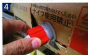
バルブの白いキャップをはずして、アルコールスプレーしてください。殺菌後、赤いコネクタをしっかりとねじ込み取り付けます。
