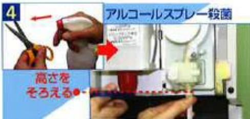
ローラーを手で一回転させた後、アルコールスプレーしたハサミで、希釈水ノズル先端と平行にチューブを切る。シロップと冷水の混ざり具合を確認してください。
