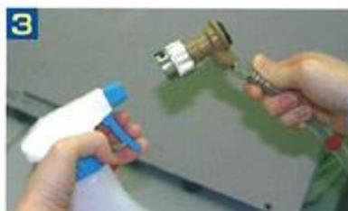
2ピン・3ピンコネクタ及び、タンク側の2ピン・3ピン接続口をアルコールスプレー殺菌し、チューブ内の残圧をキャンセルボタンにより抜きます。タンクに接続するときは、コネクタの3ピンから接続し、次に2ピンを接続する。
