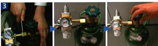
新しい炭酸ガスシリンダーを用意し、炭酸ガスレギュレーターをシリンダーに取り付ける。シリンダーの元栓バルブを開き、元圧ゲージの針がグリーンの表示のところまで上がっていることを確認する。もう一度元栓バルブを閉め、元圧ゲージの針が下がらないかを確認し、また元栓バルブを開く。
