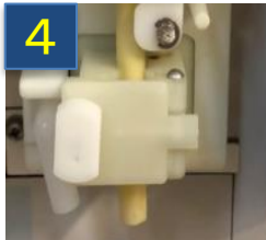
4 ノズルキャップを外し、希釈水ノズルを上記写真位置に合わせて希釈水ノズル・BIBチューブ先端をアルコールスプレーで殺菌する。
