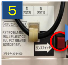
5 リンスボタンを押してノズルの洗浄を行う。
