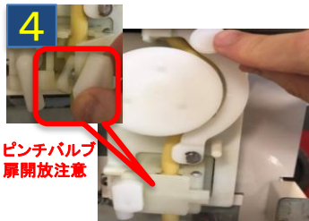
4 ふき取り後、ガイドを戻します。 注！ピンチバルブ扉はシロップ交換時以外は開けないでください
