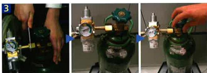
新しい炭酸ガスシリンダーを用意し、炭酸ガスレギュレーターをシリンダーに取り付ける。シリンダーの元栓バルブを開き、元圧ゲージの針がグリーン表示のところまで上がっていることを確認する。もう一度元栓バルブを閉め、元圧ゲージの針が下がらないかを確認し、また元栓バルブを開く。
