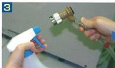
2ピン・3ピンコネクタ及び、タンク側の2ピン・3ピン接続口をアルコールスプレー殺菌し、チューブ内の残圧をキャンセルボタンにより抜きます。タンクに接続するときは、コネクタの3ピンから接続し、次に2ピンを接続する。
