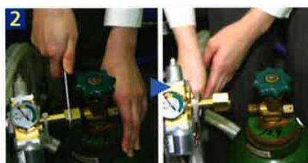
炭酸ガスレギュレーターをスパナで緩めて、空のシリンダーから外す。その際、炭酸ガスレギュレーターが落下しないように気をつけます。
