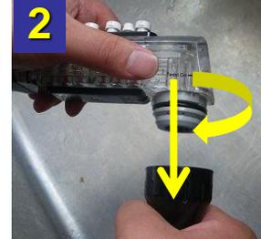
先端のノズルを外してください。
