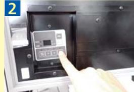
MBリンススイッチを長押しする。ミキシングボウル回路及びお湯回路を自動的に湯洗浄します。
