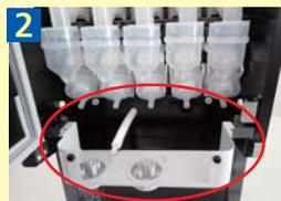
ミキシングボウルから注出チューブをはずす。湯注出チューブを注出ノズル、湯中継パイプからははずす。
