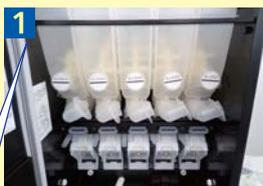
ミキシングボウルの洗浄の際に、粉キャニスターの洗浄も行なう。粉受け前アングルの化粧ねじ2本を緩め（もしくははずして）取りはずす。
