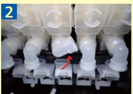
粉原料ガイドを反時計回りに90度回し、キャップを取り付ける。
