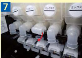
キャップをはずし粉原料ガイドを時計回りに90度回して粉キャニスターを固定する。
