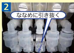
キャップを粉原料ガイドに取り付ける。固定ロックを押しながらミキサーボディー下をさげてはずし、そのまま斜めに引き抜くようにははずす。
