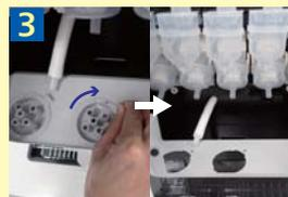
注出ノズルの固定爪を持ち上げながら矢印方向(時計回り)に回してから、上方向に抜く。
