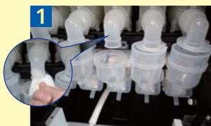
ミキサーカバーを取りはずし、ミキサーシュートを取りはずす。キャスター出口のガイド内をキッチンペーパーなどでふき取る。ミキサーボディー上を取りはずす。
