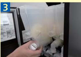
粉キャニスターを手前に引いて取りはずす。粉キャニスターを中性洗剤で洗浄する。浄後は流水で洗剤を落とす。その後清潔な乾いた布で水分を拭き取る。
