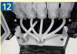
注出ノズル、注出チューブ、カバーを元通りに取り付ける。注出ノズルの飲料出口をアルコールスプレーで殺菌する。
