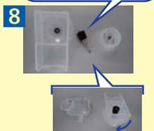
ジョイントを押さえながらインペラを時計回りに回転させ、取り付ける。Oリングとミキサーボディ下を組付け、必ずロックを閉じる。
