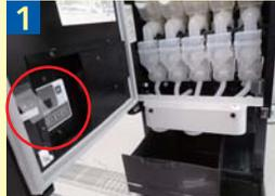
販売可スイッチを「ON」にする。ドリフトレイすのこを取りはずし、カスパケツを引き出し、注出ノズルの下にセットする。
