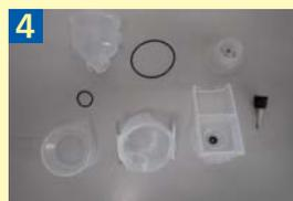
中性洗剤を使用してぬるま湯で洗浄する。ジョイントのねじ部と軸受け部は汚れが溜まりやすいので、ブラシで洗浄する。
