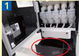
ドリフトレイすのこを取りはずし、カスパケツを引き出し、注出ノズルの下にセットする。
