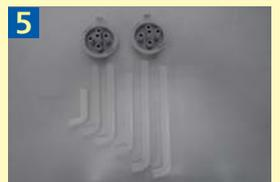
注出ノズル、注出チューブを中性洗剤を使用してぬるま湯で洗浄する。洗浄後は流水で洗剤を落とし、乾いた布で水分を拭き取る。その後アルコールスプレーで殺菌する。
