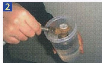
2 コップにお湯を入れて2ピン・3ピンコネクタをお湯に浸けて洗浄する。
